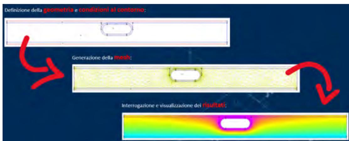
Img 4 – approccio alla simulazione termodinamica agli elementi finiti (sezione tipo modulo HEATILE)
