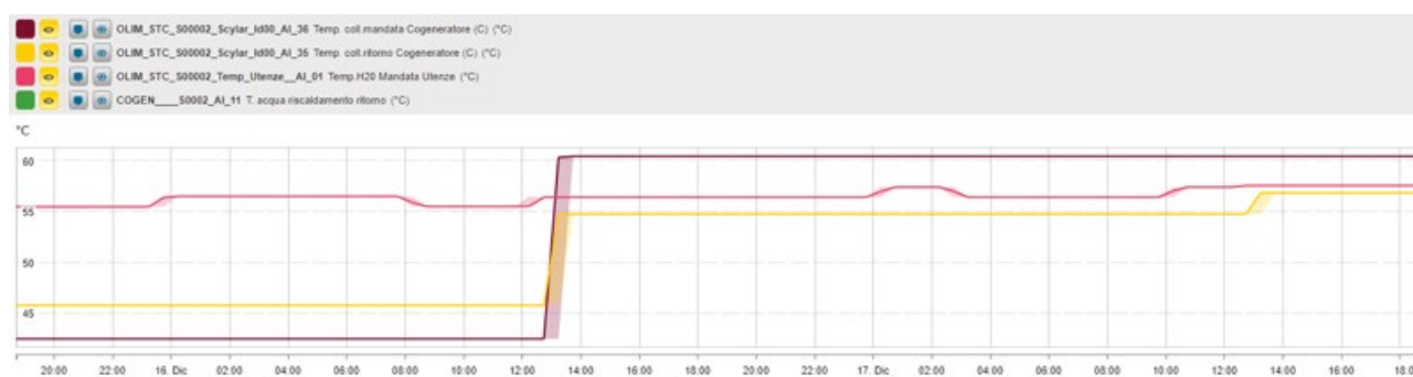
Figura 4: Il BMS permette di monitorare le temperature del cogeneratore.
