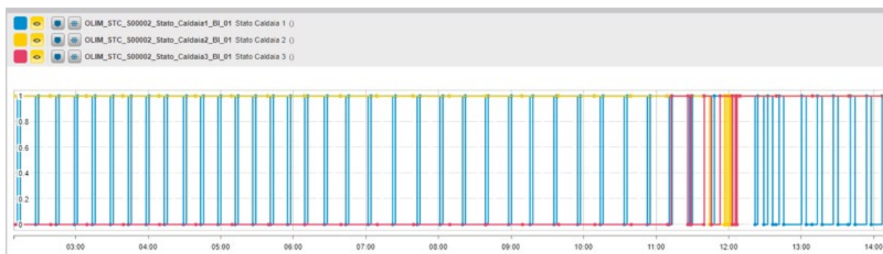
Figura 3: Andamento dello stato delle caldaie monitorato dal BMS.
