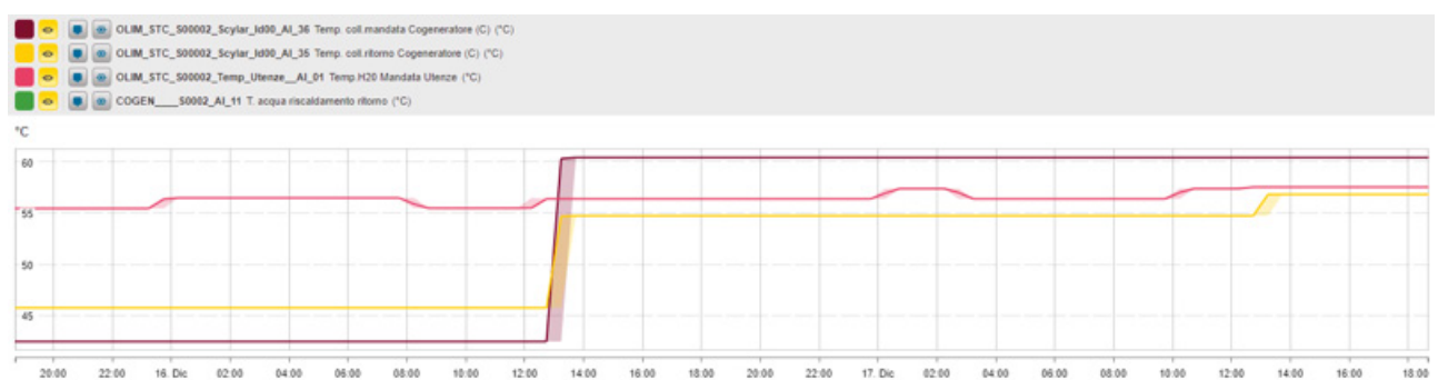
Figura 4: Il BMS permette di monitorare le temperature del cogeneratore.
