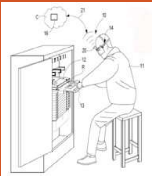
Figura 2: AR per Supporto all'installazione e alla manutenzione di strutture complesse
