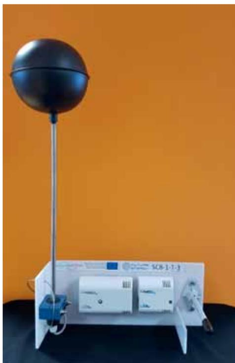
**Figura 1. Sistema di monitoraggio wireless del comfort ambientale indoor**
