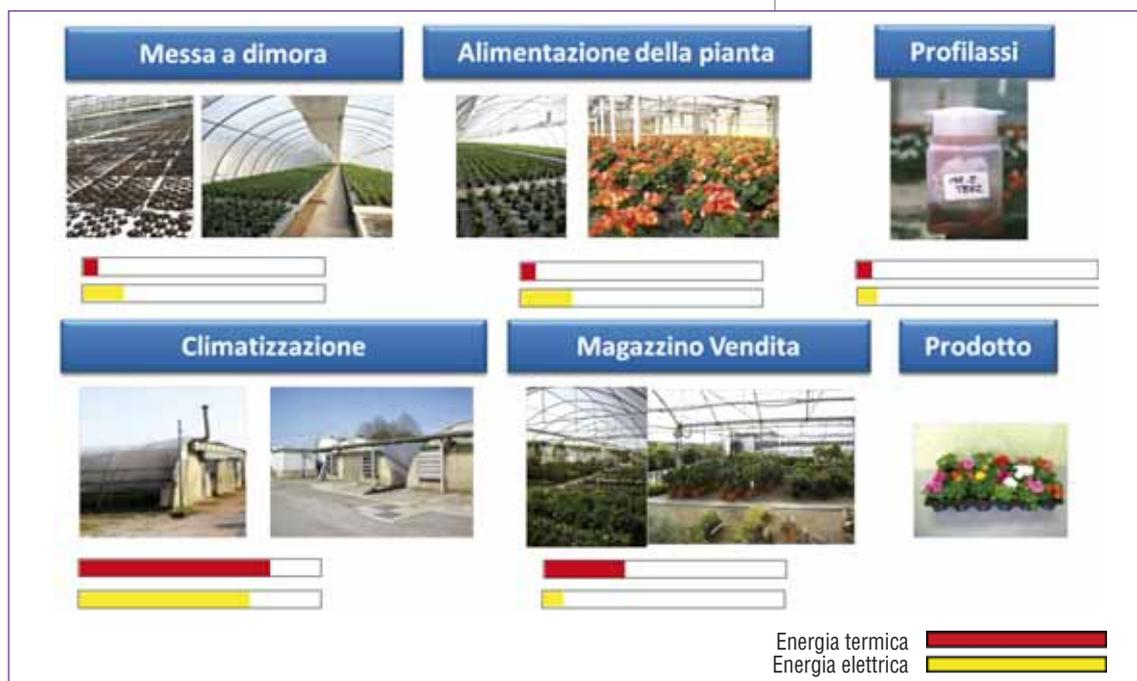
Figura 1. Consumo di energia termica ed elettrica dalle varie fasi del processo produttivo
