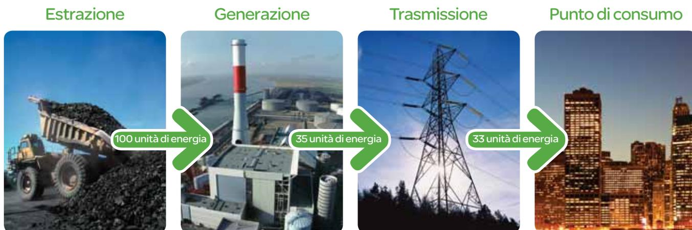
A causa delle inevitabili dispersioni lungo la linea, 33 unità di energia al punto di consumo richiedono 100 unità di energia primaria
