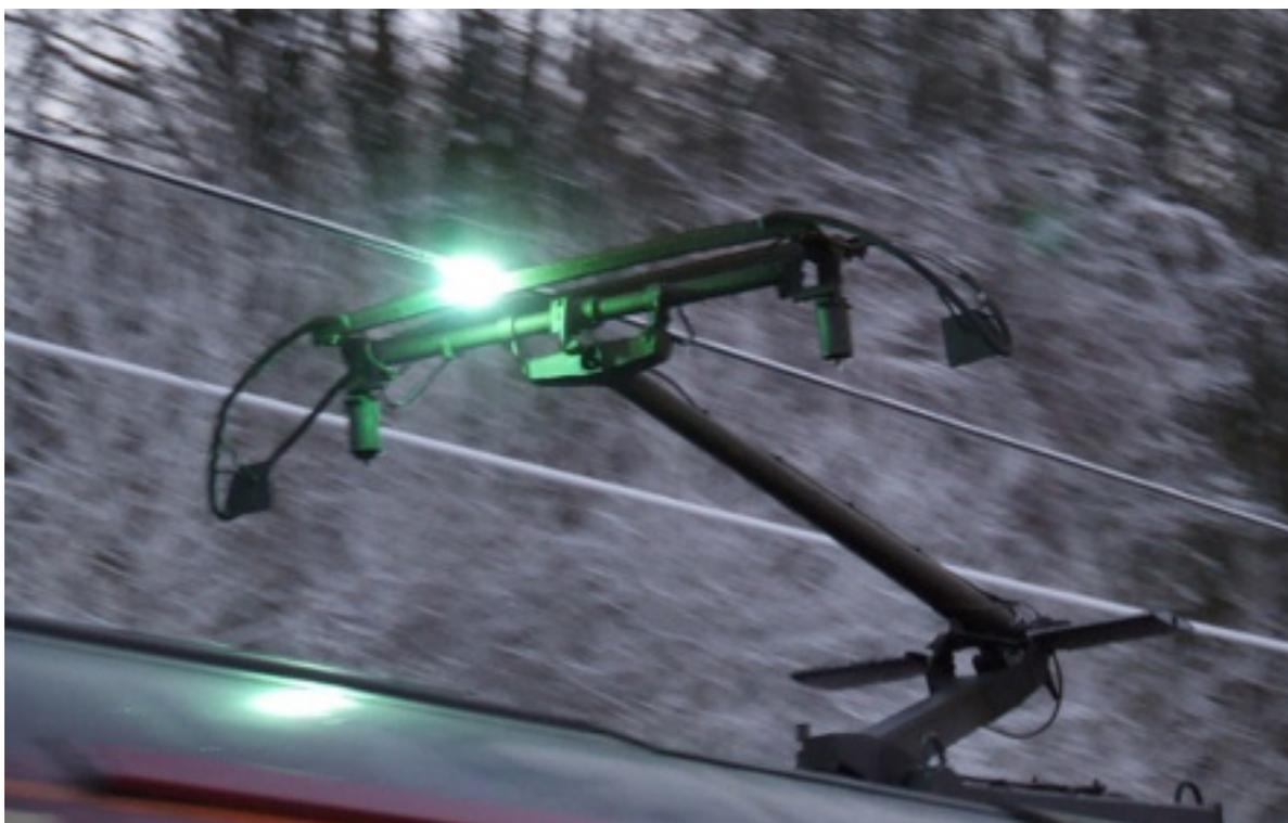
Arco elettrico al pantografo
