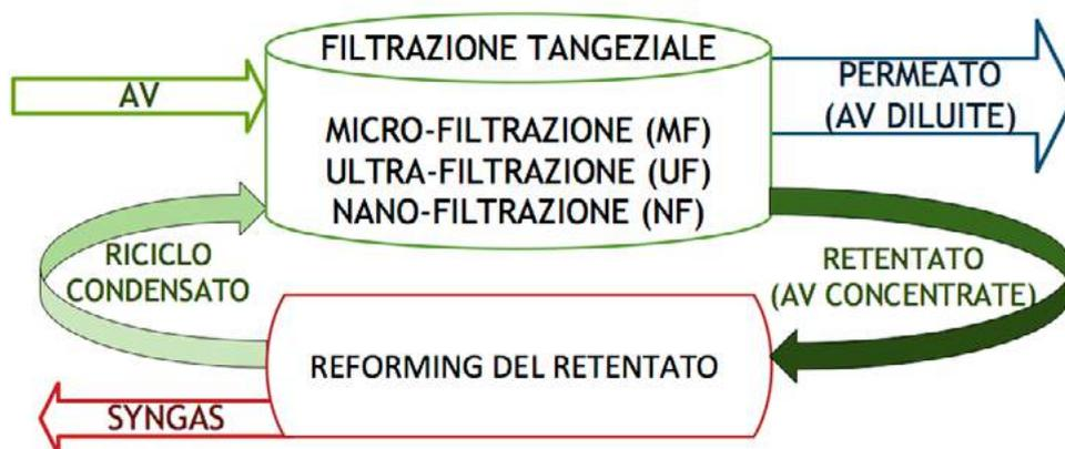
Fig. 1 - Processo per il trattamento delle acque di vegetazione.
