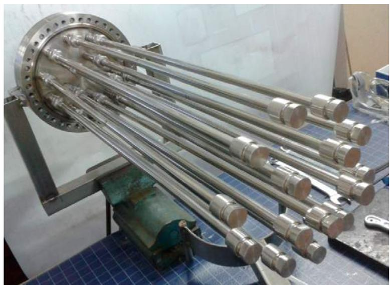
Fig. 3 - Particolare di 15 tubi in lega Pd-Ag prima dell'assemblaggio di un modulo a membrana.
